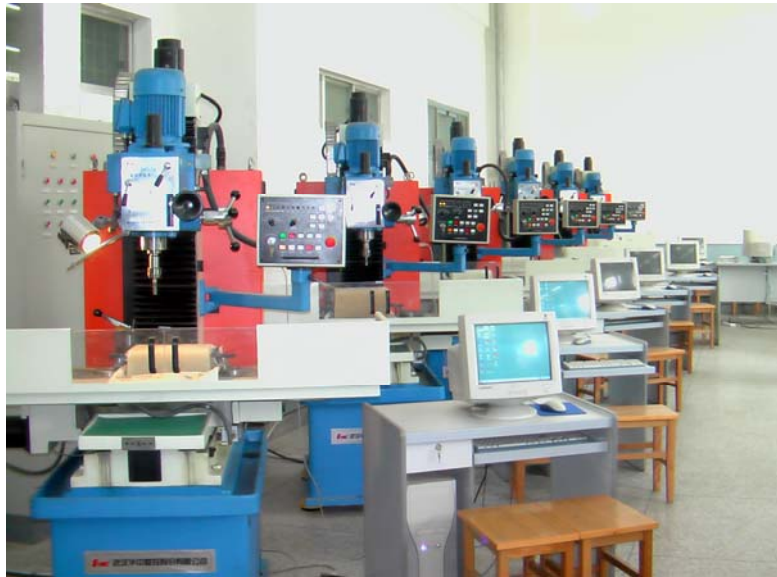
① ZJK7532A 多功能教学型数控钻铣床(华中 I 型数控实验系统)
