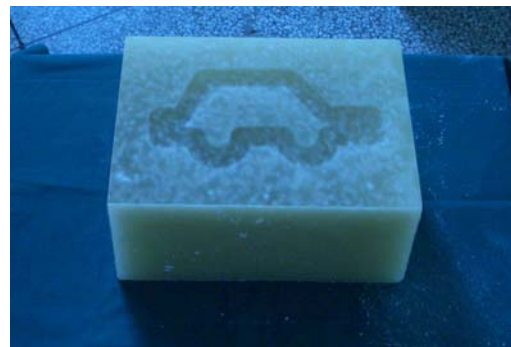
② 在蜡模上铣削小汽车图形
